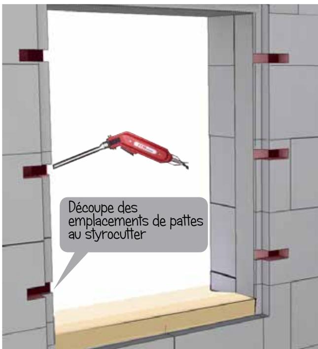
Il faudra utiliser des pattes de fixation permettant de compenser l'épaisseur de polystyrène en tableau.
