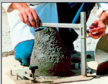
**Pour une fluidité idéale du béton la valeur de l'affaissement doit se situer entre 140 et 180.**
